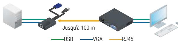
Déport KVM VGA / USB sur RJ45 - 100 m
