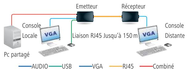
Switch KVM 2 ports VGA / USB + prolongateur 150 m
