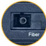
**Port fibre monomode OS1/OS2 SC simplex : 1310/1550 nm !**
